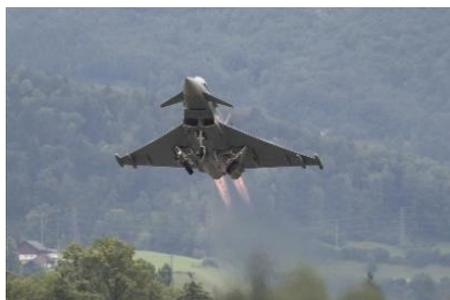
Das maximale Startgewicht ist 23 Tonnen. Er braucht 700 Meter zum Starten. Sie braucht 2 Minuten und 30 Sekunden, um von 0 Meter auf 10'670 Meter zu steigen.
